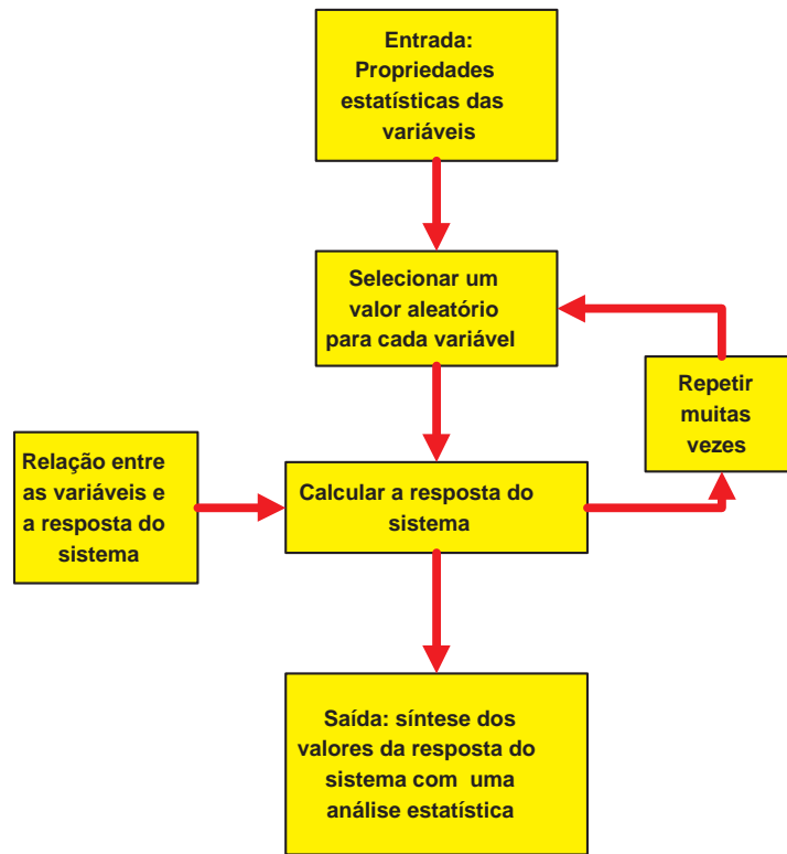
Figura 5.6: Fluxograma geral para análise probabilística de estruturas
